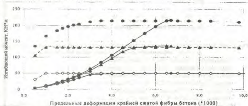
Рис. 2 Зависимость несущей способности железобетонного изгибаемого элемента от предельных деформаций (по диаграммам до преобразования)
