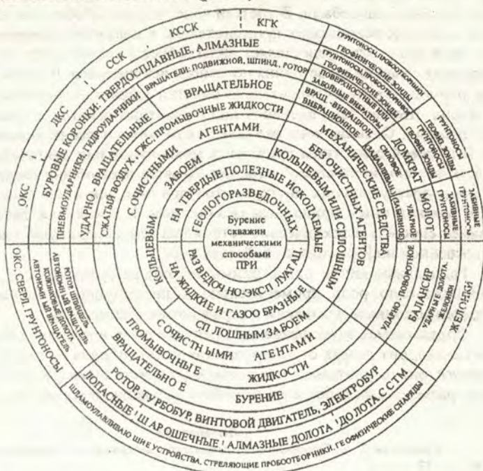
Рис 1. Классификация способов бурения и опробования разведочных скважин
