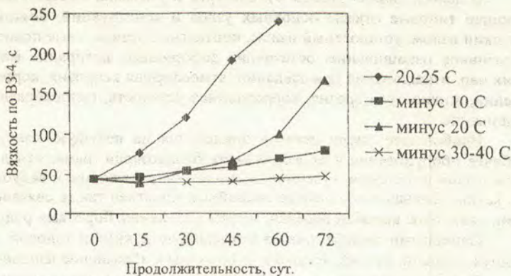
Рис. Изменение вязкости карбамидоформальдегидной смолы КФЖ-М в процессе хранения при отрицательных температурах
