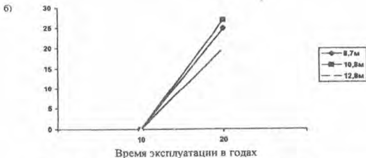
Рис.2. График распределения балок в % от общего числа, имеющих участки поврежденных коррозией бетона (а) и арматуры (б) в зависимости от времени эксплуатации
