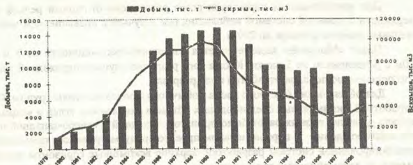
Рис. 1. График выполнения добычных и вскрышных работ на разрезе "Нерюнгринский"
