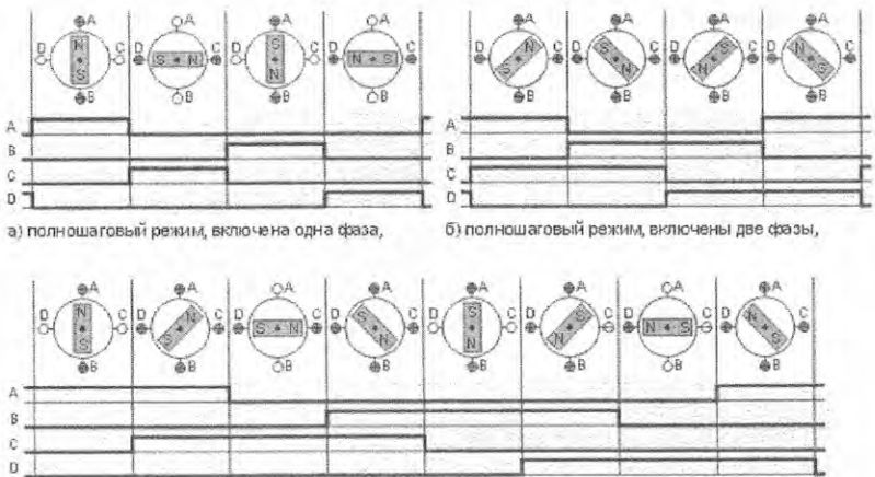
Рис. 1. Фазы работы шагового двигателя
