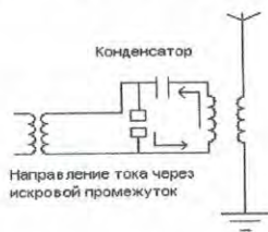
Рис. 3. Поведение тока в Катушке Тесла на искровом промежутке, в момент разрядки через разрядный промежуток
