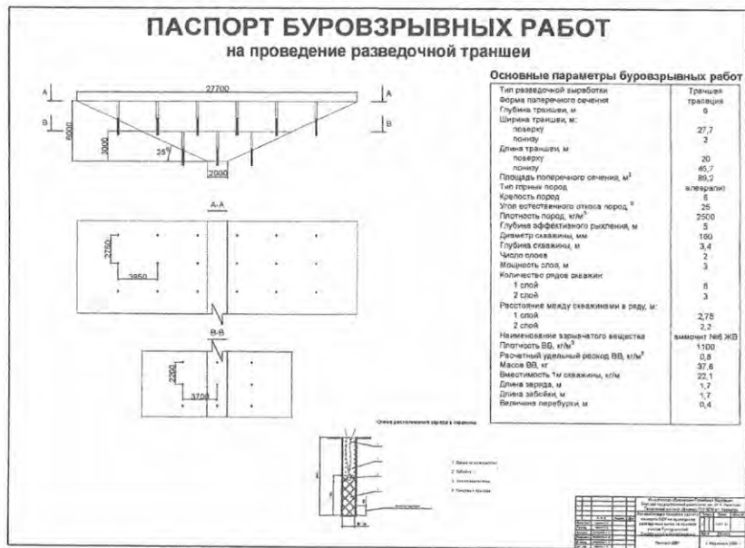
Рис. 5. Графическая интерпретация паспорта БВР на проведение разведочной траншеи
