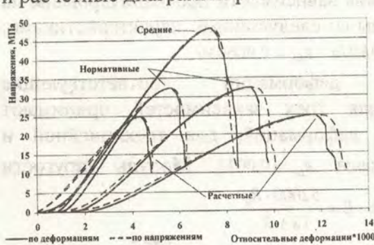
Рис. 2 Средние, нормативны и расчетные диаграммы состояния бетона « \sigma - \epsilon » партии образцов испытанных при температуре -60^{\circ}\text{C}
