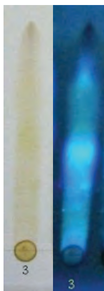
Рис. 1. Хроматограммы экстрактов брусники а) в видимом свете; б) в УФ свете
