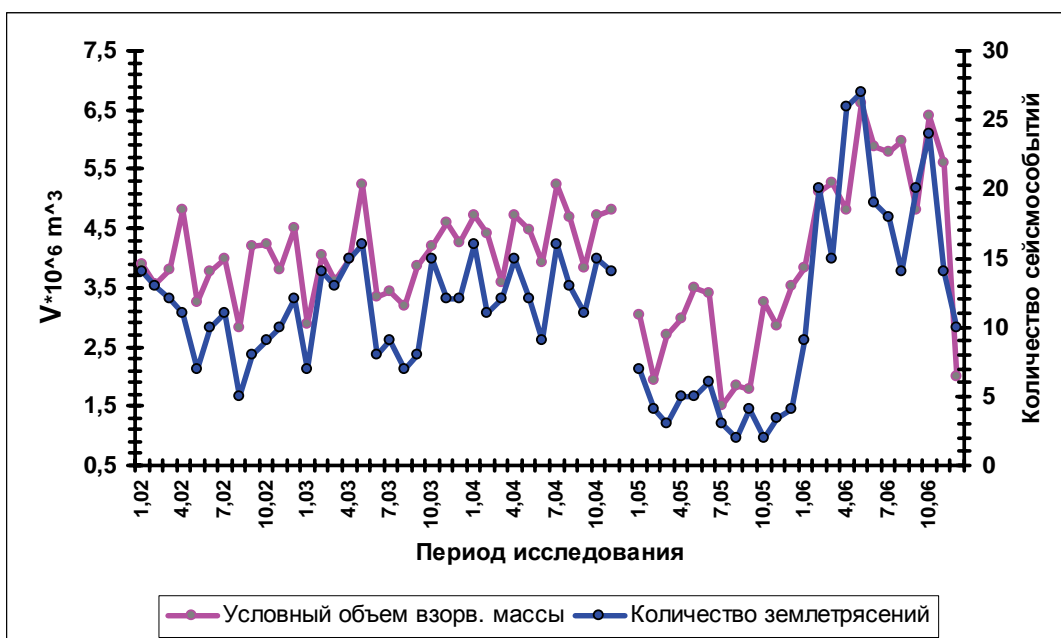
Рис. 1. Графики изменения объема взрывающей массы и количества близких землетрясений в месяц, за период 1.01.02 - 30.12.06 г.
