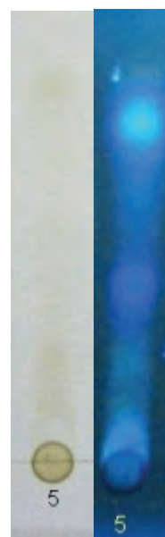
Рис. 6. Хроматограммы экстрактов голубики а) в видимом свете; б) в УФ свете
