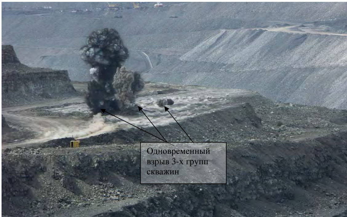
Рис. 10. Взрыв блока с использованием системы СИНВ, одновременный взрыв несколько групп скважин
