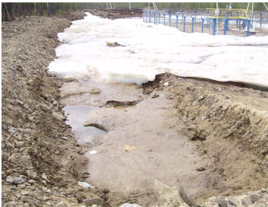
Рис. 3. Выход наледных вод на участке изыскания (июнь 2010 г.)
