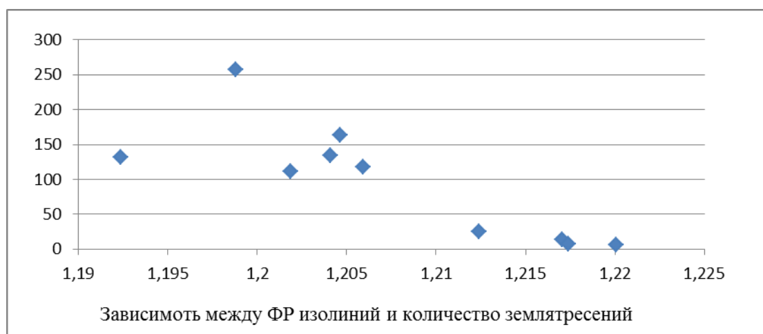
Рис. 8. Изолинии: графическое представление зависимости количества событий от фрактальных размерностей выбранных площадок
