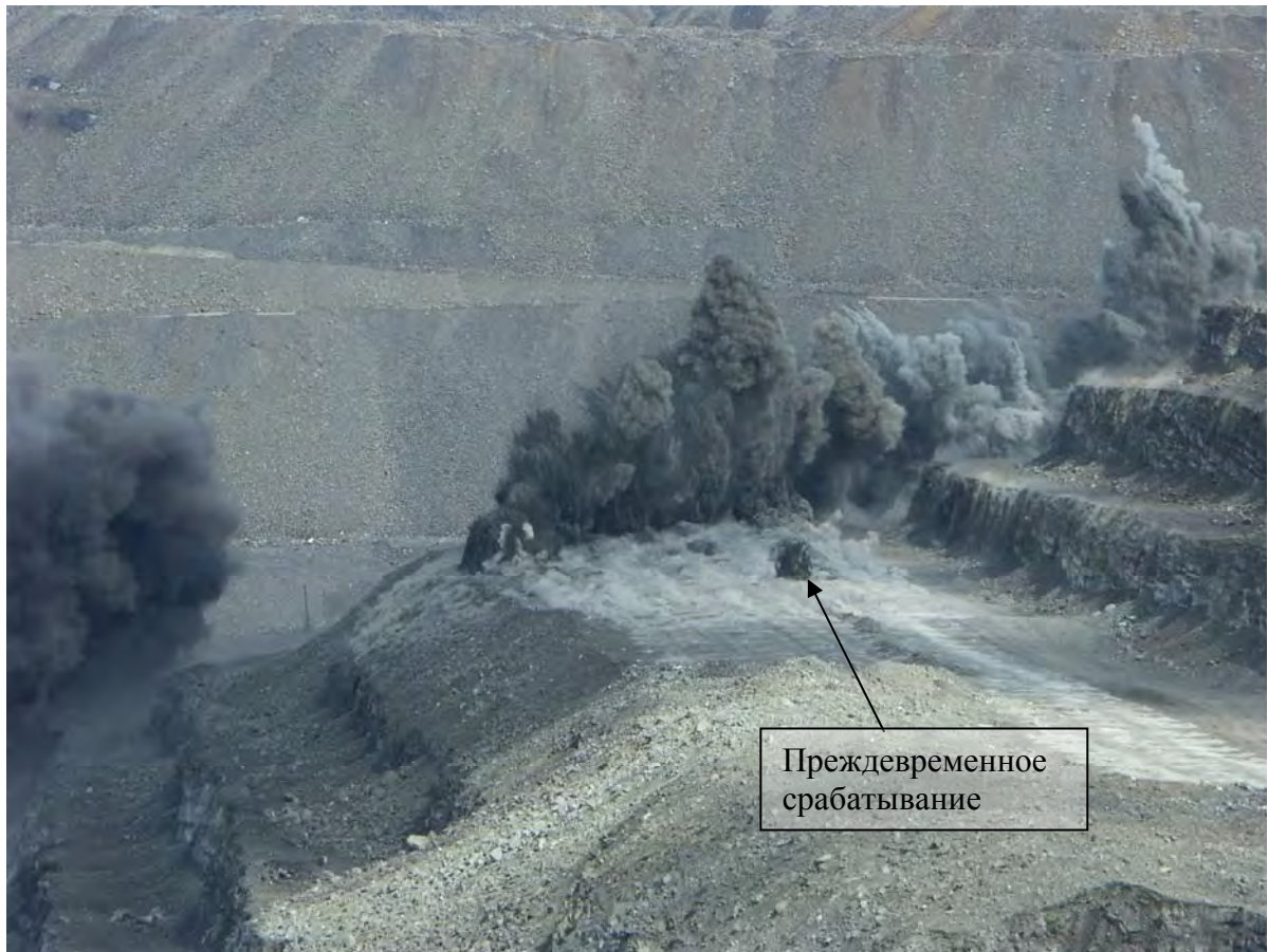
Рис. 9. Взрыв блока с использованием системы СИНВ
