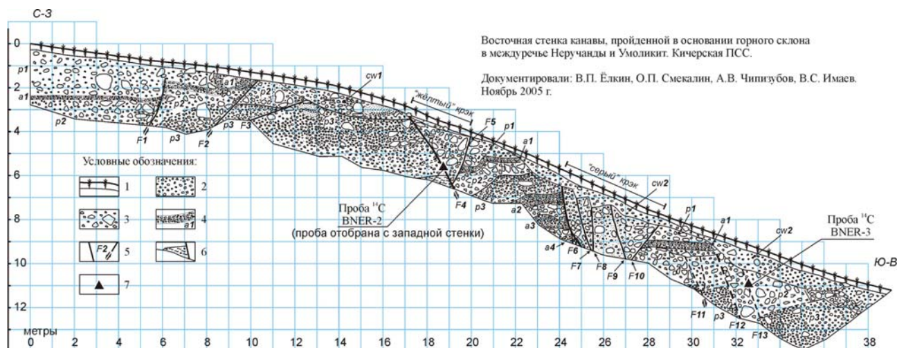
Рис. 7. Схема разреза восточной стенки канавы, пройденной в основании горного склона в междуречье Неручанды и Умоликита (992 км трассы ВСТО). Документировали В.П. Ёлкин, О.П. Смекалин, А.В. Чипизубов, В.С. Имаев (ноябрь 2005 г.). Условные обозначения: 1 – современный почвенно-растительный слой чёрного цвета, представленный супесью с включениями валунов и гальки; 2 – гравийно-галечниковый грунт с крупнозернистым песчаным заполнителем; 3 – валунно-галечниковый грунт с грубозернистым песчаным заполнителем; 4 – прослой сортированного ориентированного по напластаванию гравийно-галечникового аллювия; 5 – разрывные нарушения с отчетливо выраженной плоскостью смещения или отрыва, и возможно, мало амплитудные трещины нарушения целостности (пунктирные линии) с указанием направления смещения; 6 – суглинок зелёного цвета с включениями мелкообломочного материала; 7 – места отбора проб на радиоуглеродный анализ
