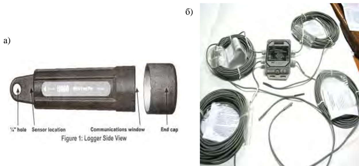
Рис. 1. Общий вид логгера (а – одноканальный, б – многоканальный)
