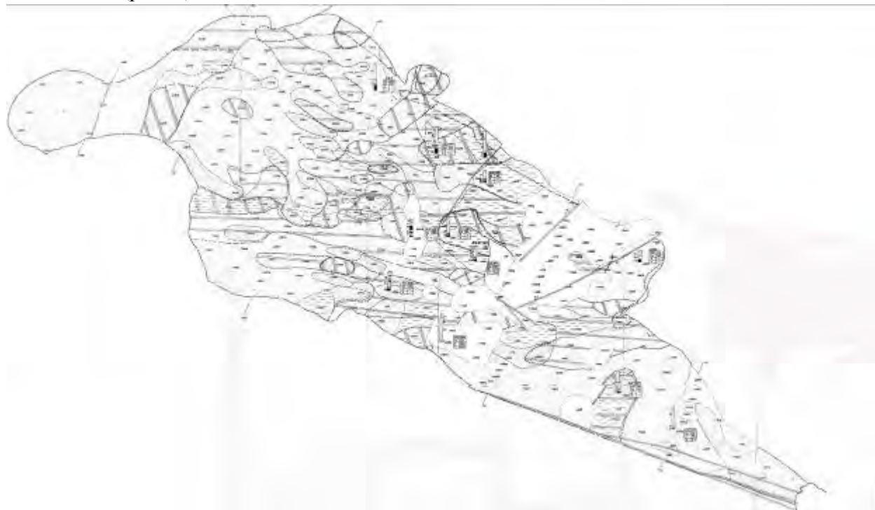
Рис. 1. Схематическая литолого–прочностная карта непосредственной кровли пласта К 4
