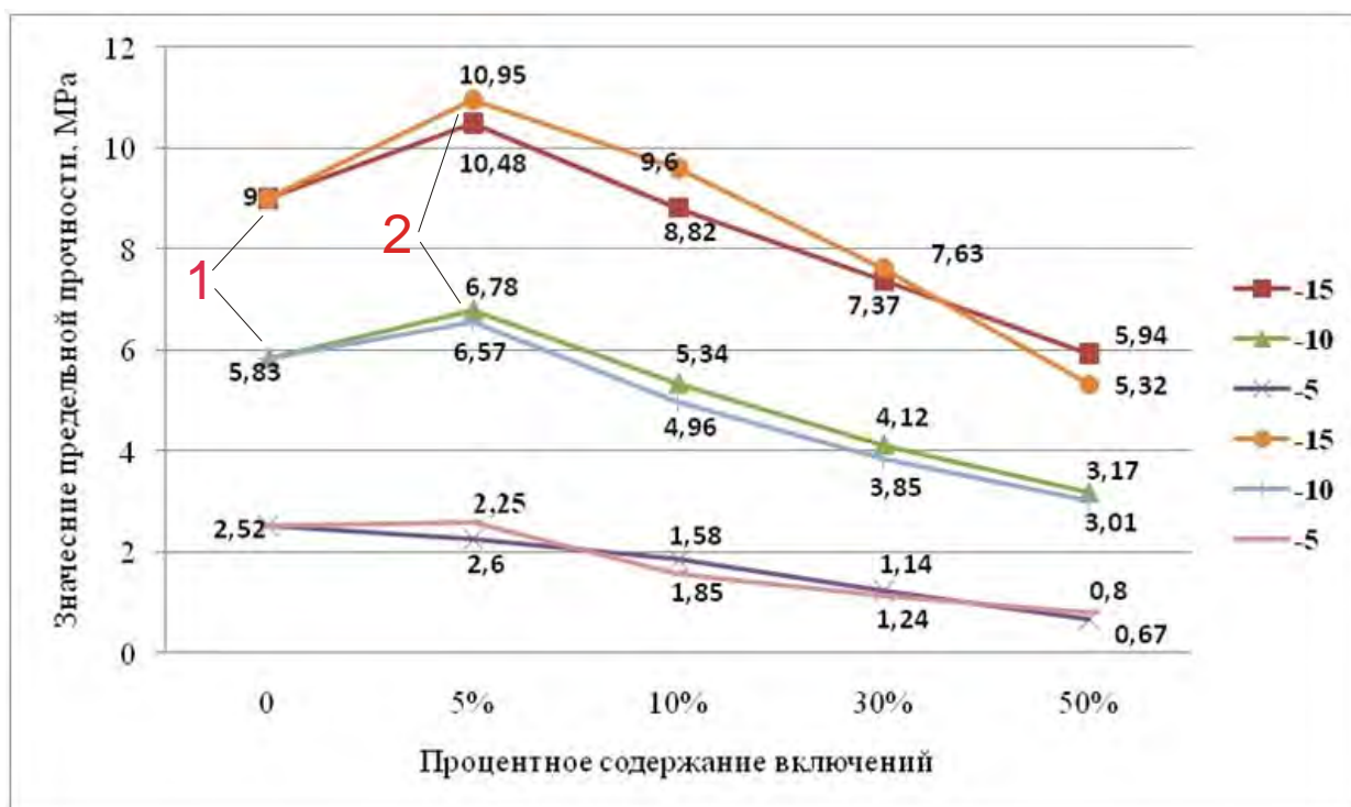
Рис. 1. Изменение предела прочности мерзлых дисперсных пород в зависимости от размера (5 и 10 мм) и количества (5-50 %) твердых включений
