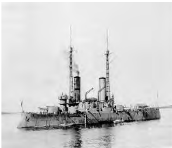
Гиперboloидные мачты броненосца «Император Павел I», Кронштадт, 1912
