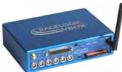
Рис. 2. Устройство VBOX 3i
