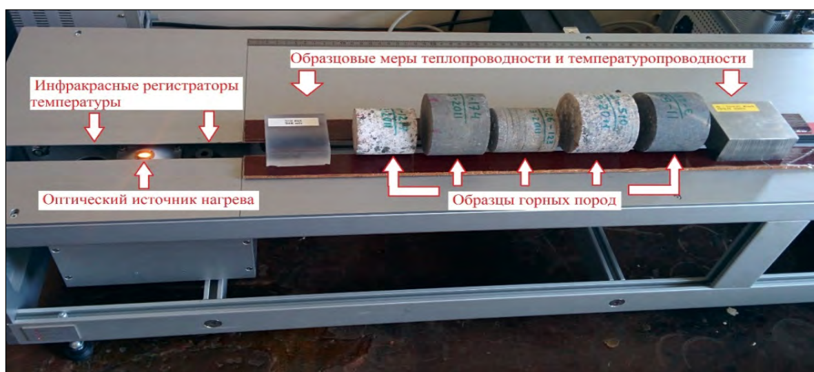
Рис. 3. Принцип метода оптического сканирования.
