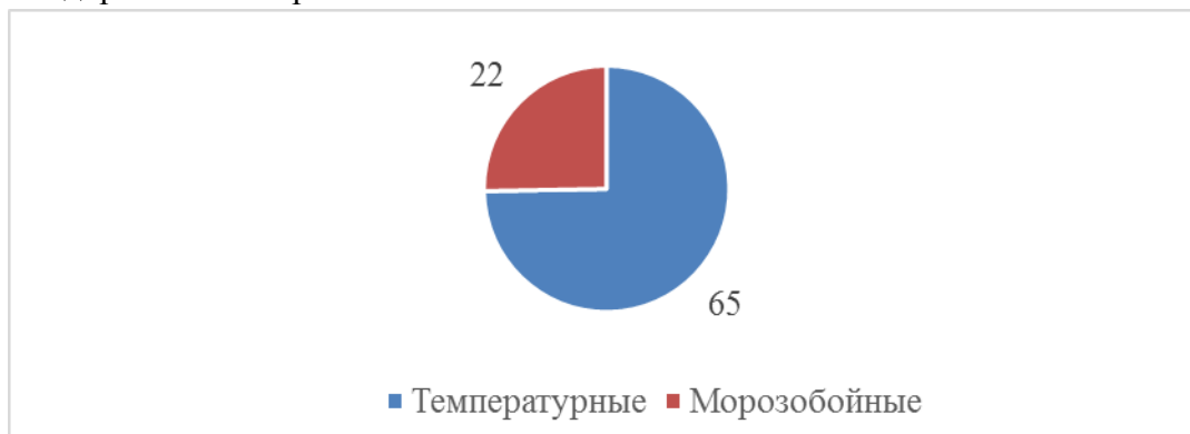
Рис. 5. Соотношение температурных и морозобойных трещин, выявленных на участке федерального дороги «Виллой» на км 159+00 – 160+00
