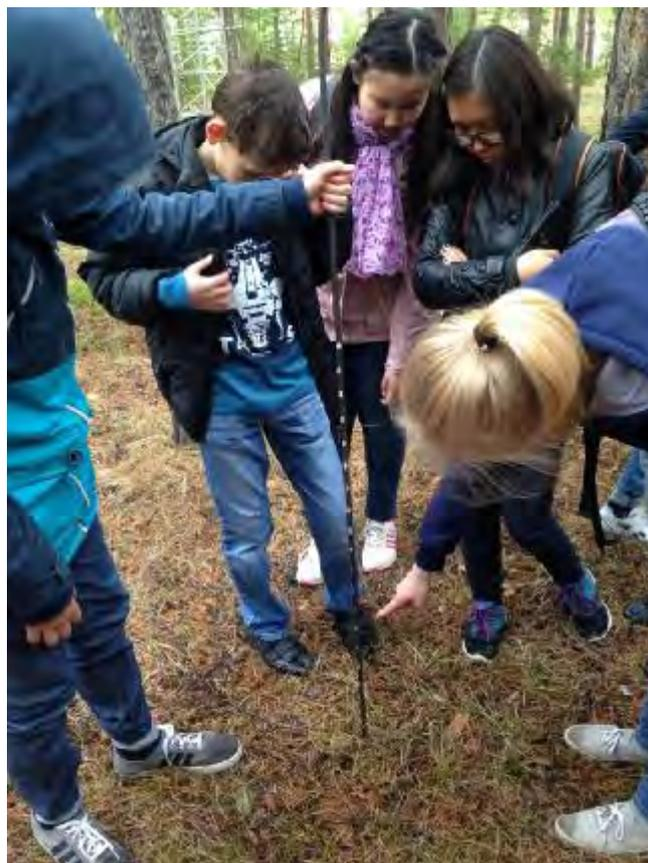
Рис. 1. Измерение мощности протаивания грунта металлическим щупом
