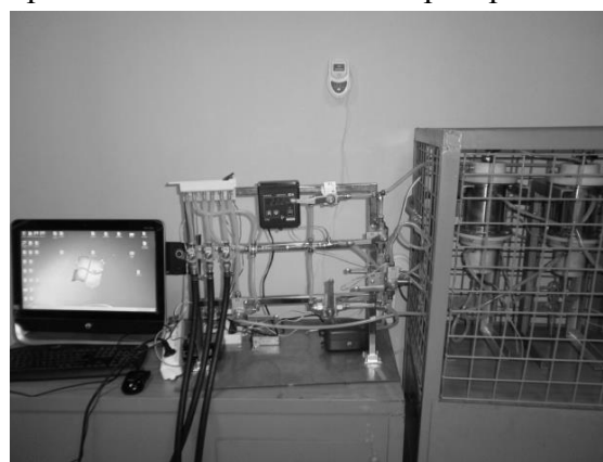
Рис. 1. Схема (слева) и внешний вид (справа) установки по плазмокатализической конверсии синтез-газа. Д1-Д3 – датчики расхода газа, Р – реактор, ВГ – высоковольтный генератор
