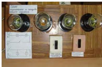
Рис. 2. Последовательное и параллельное соединения проводников
