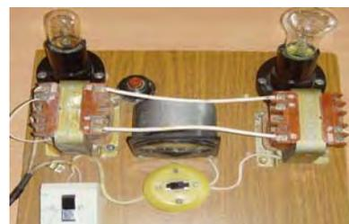
Рис. 8. Трансформатор
