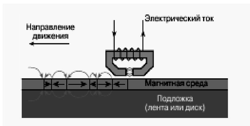
Рис.2. Схема магнитного способа записи
