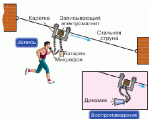
Рис.1. Схема магнитной записи на стальную струну
