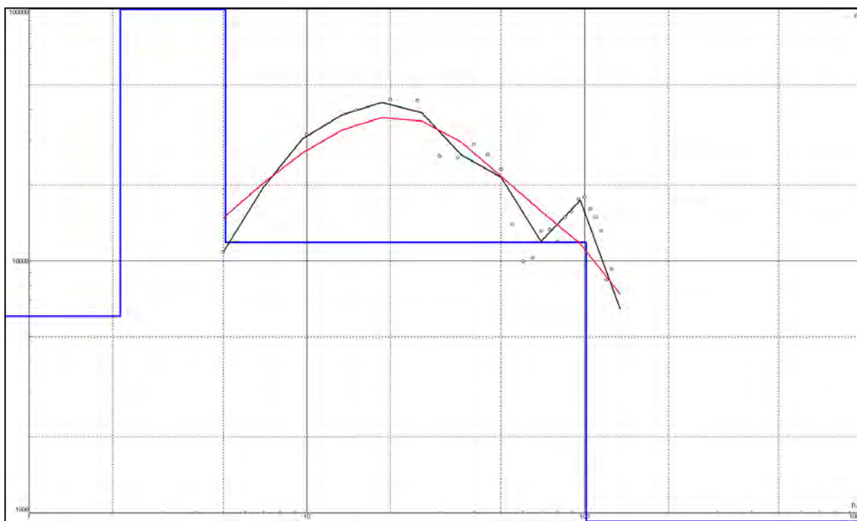
Рис. 2. Типичная кривая зондирования, точка зондирования по профилю на пикете 1286+75
