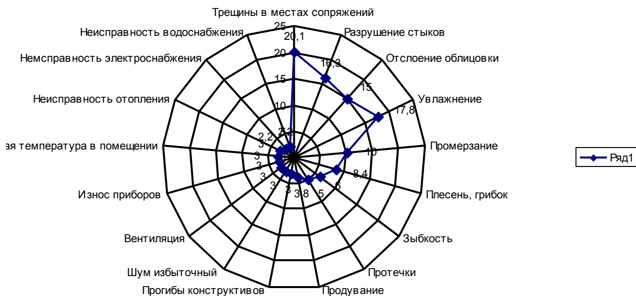
Рис. 2. Распределение дефектов модульных 2-х этажных жилых домов типа УГПД
