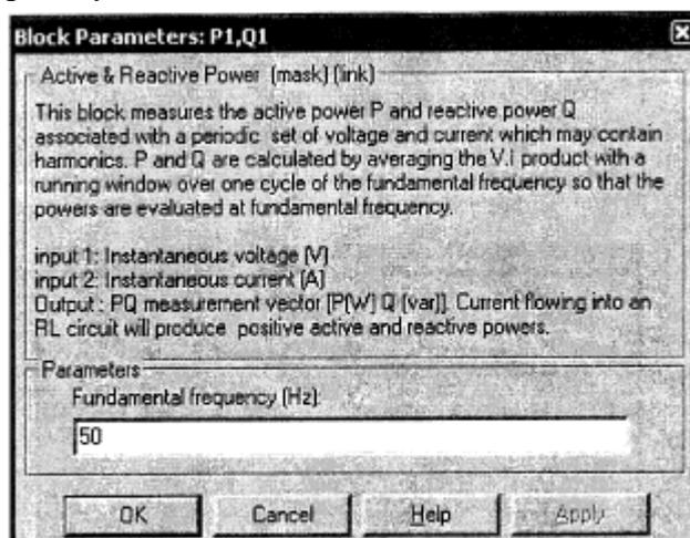
Рисунок 11 – Окно настройки блока измерения мощности
