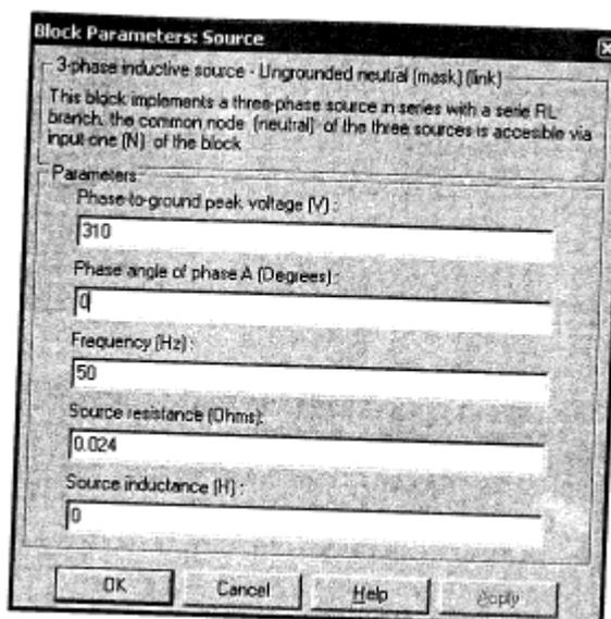
Рисунок 10 – Окно настройки параметров трехфазного источника питания
