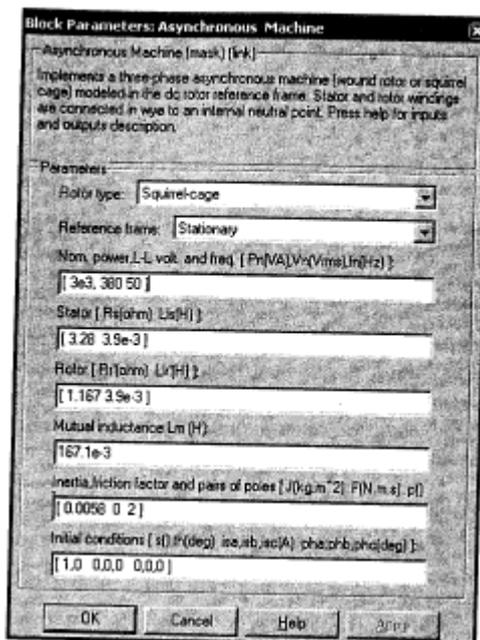
Рисунок 8 – Окно настройки параметров асинхронной машины
