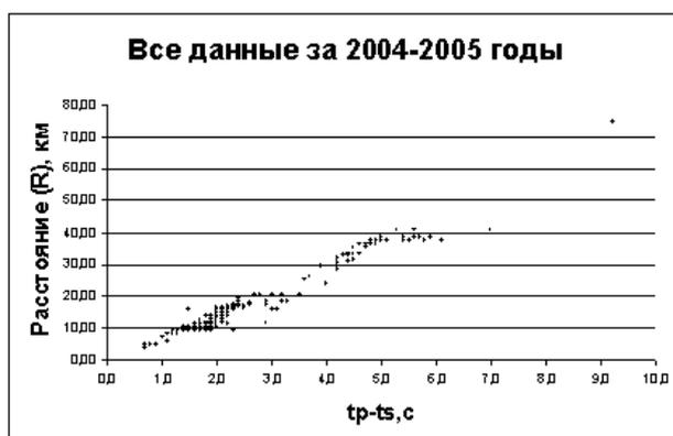
**Рис. 5.** Зависимость эпицентрального расстояния от фиктивного времени для землетрясений и взрывов за 2004 - 2005г.
