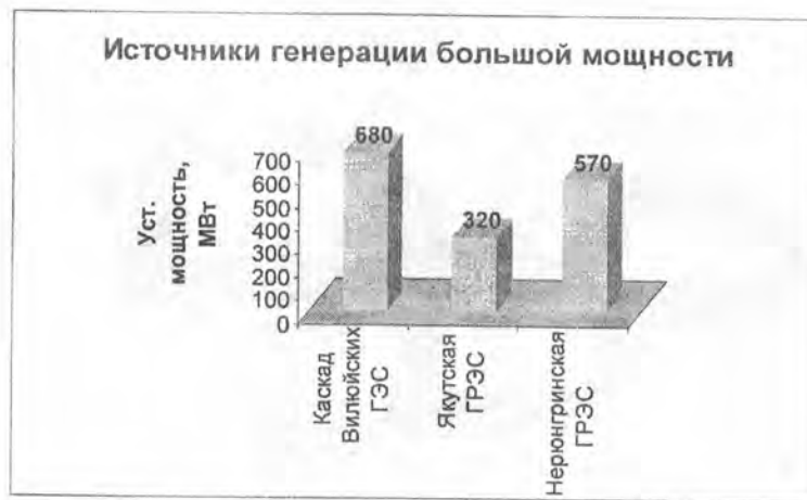
Рис. 1. Источники генерации большой мощности
