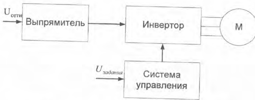
Рис. 1. Функциональная схема частотно-регулируемого привода
