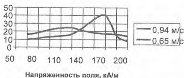
Рис. 1. Повышение прочности цементного камня в зависимости от скорости потока воды и напряженности электромагнитного поля
