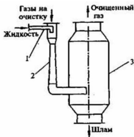
Рис. 1. Скруббер Вентури: 1 –орошающая форсунка; 2 – труба Вентури; 3 –каплеуловитель
