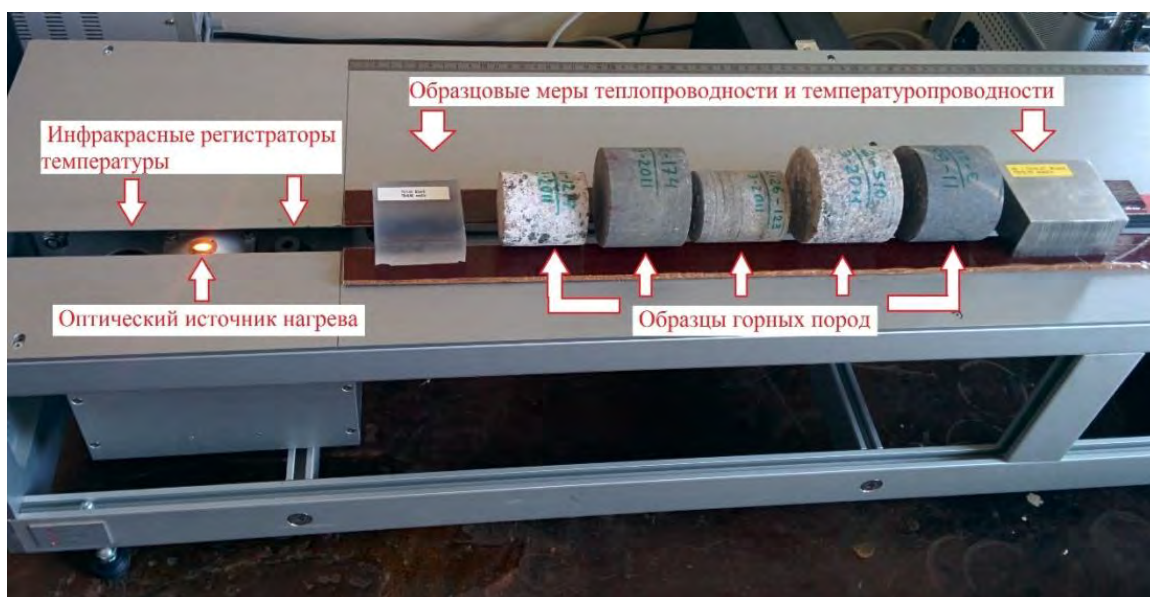
Рис. 2. Установка оптического сканирования керновых образцов TCS
