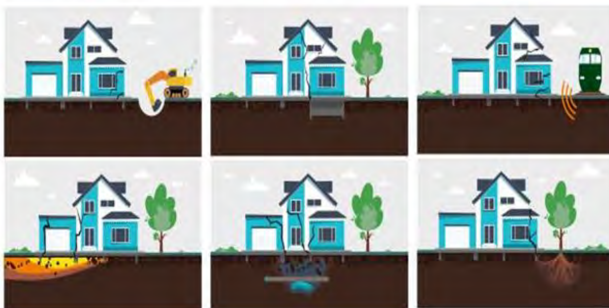
Рис. 1. Основные причины просадки здания
