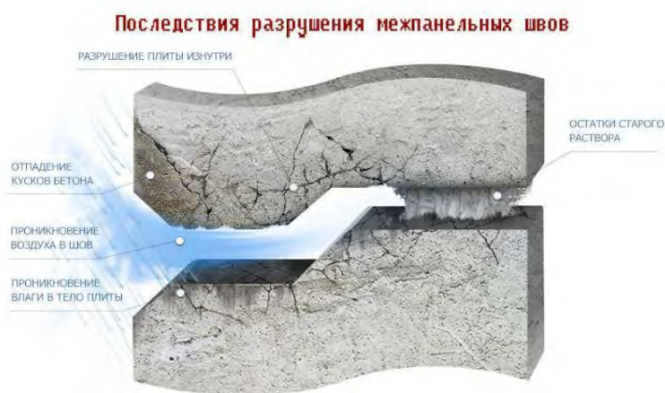
Рис. 1. Последствия разрушения межпанельных швов
