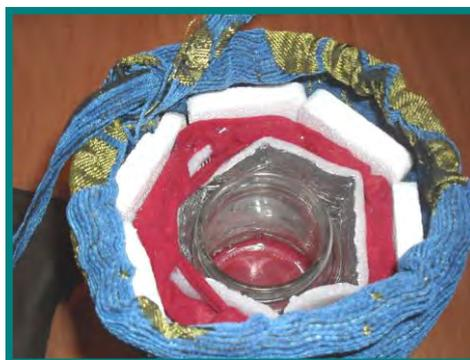
Чтобы защитить термос от повреждений поместил его в футляр, из плотной ткани. Затем я провел опыт с самодельным термосом и заводским. Результаты эксперимента показали, что температура воды в самодельном термосе была чуть ниже, чем в заводском. В заводском термосе используется колба с двойными стенками, между которыми находится вакуум. Но выше, чем в опытах с отдельными материалами.
