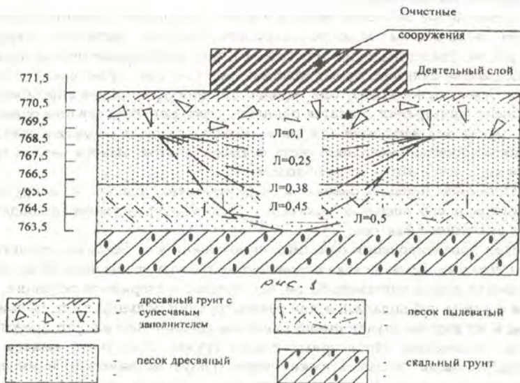
Рис. 1. Инженерно-геологические условия строительной площадки Беркакитских очистных сооружений
