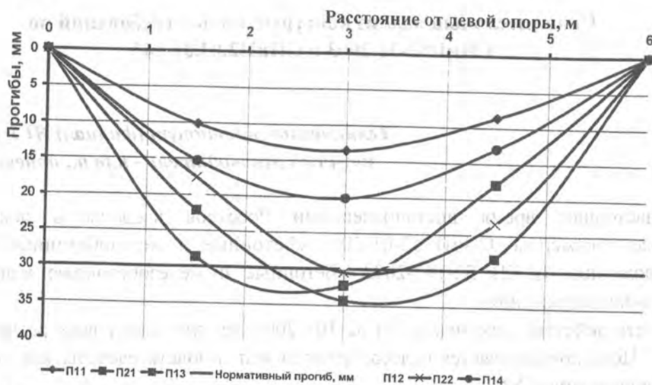
Рис. 14. Прогибы разрезных прогонов покрытия СОШ № 7
