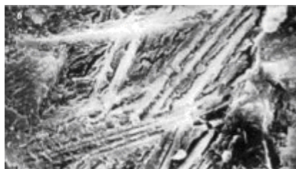
Рис. 4. Цементный камень после введения нанотрубок
