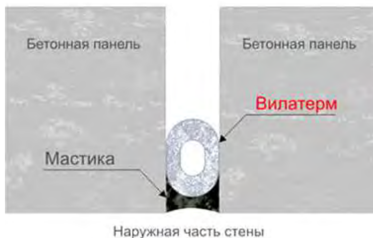
Рис. 2. Установка утеплителя «Вилатерм»
