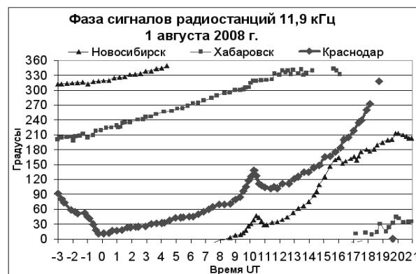
Рис. 1. Суточный ход амплитуды (а) и фазы (б) сигналов СДВ радиостанций близ Новосибирска, Краснодара и Хабаровска на частоте 11,9 кГц.
