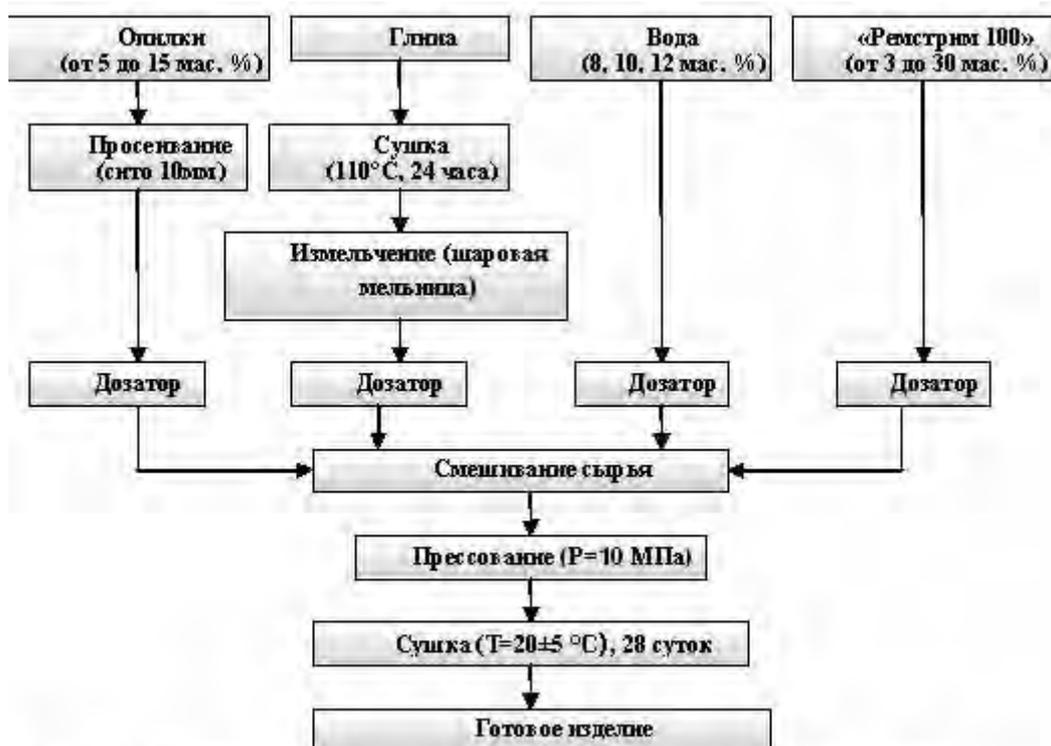
Рис. 1. Технологическая схема изготовления глиносырьцевых изделий
