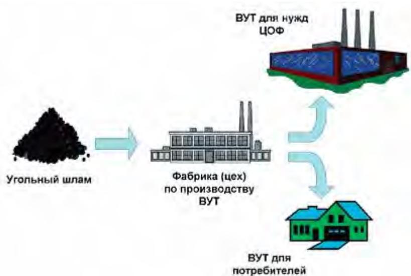
Рис. 2. Схема переработки угольных шламов в водоугольное топливо и транспортирование потребителям
