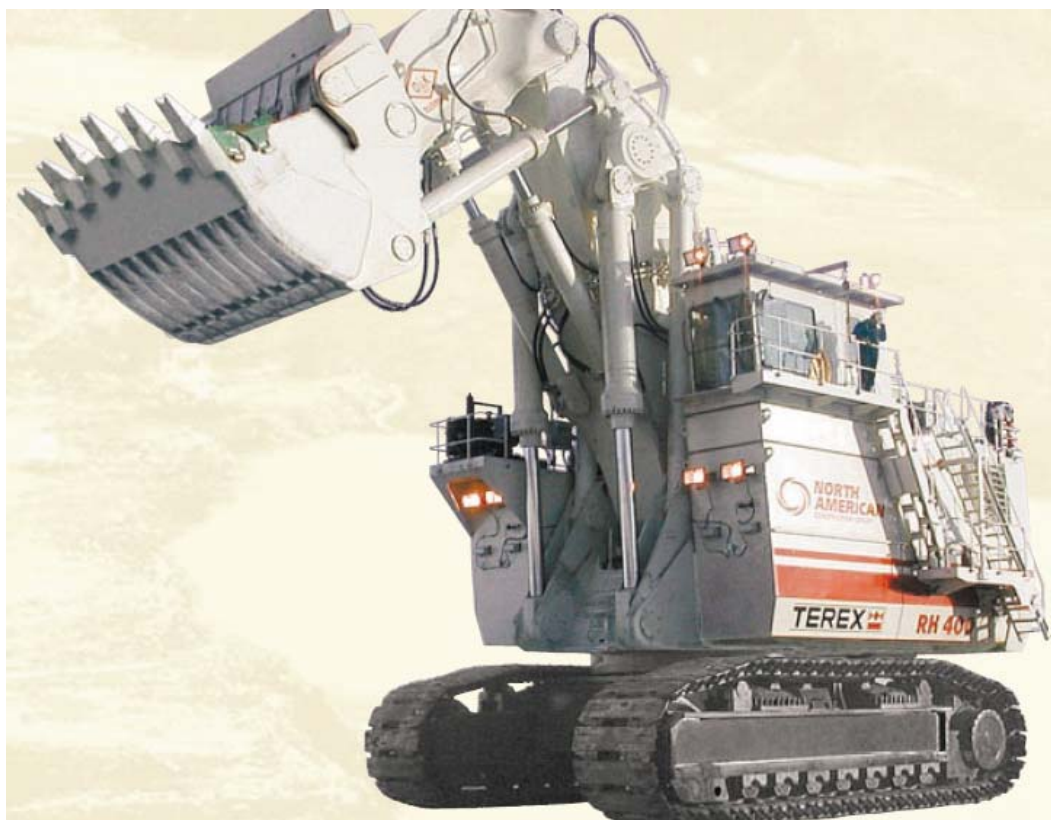
Рис. 1. Крупнейший в мире гидравлический экскаватор RH-400 с ковшом "прямая лопата" вместимостью 45 м 3 и эксплуатационной массой 1000 тонн
