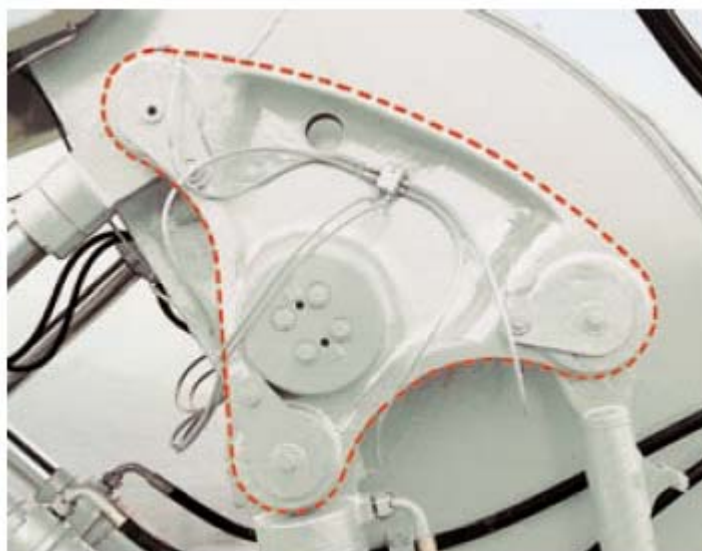
Рис. 3. Кулиса механизма "Tri-Power" позволяющего экономить энергию на подъём гружёного ковша
