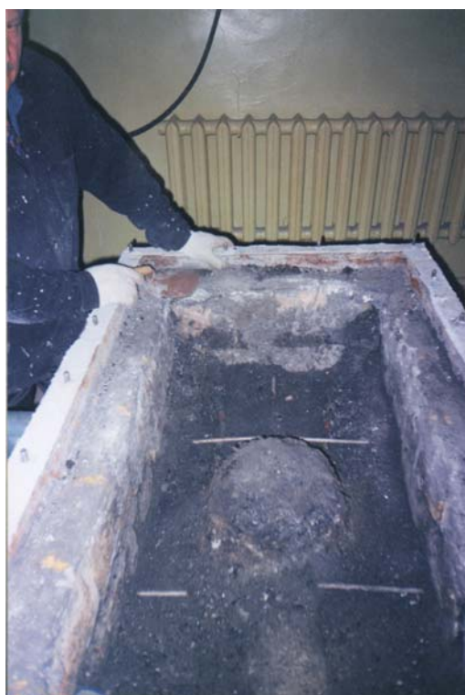
Рис. 5. Модель подземного газогенератора в процессе разгрузки
