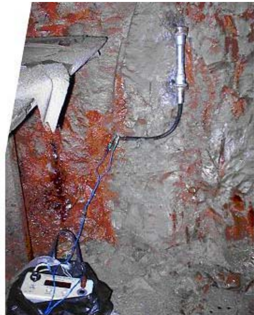
Рис. 2. Деформометр ТБ-200 ВНИИГ №1070 установлен на пикете ПК 2+5 по левой стороне от входа в штольню №2, в нише на высоте 1 м от основания
