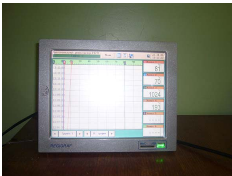
Рис. 4. Электронный регистратор REGIGRAF (Ф1771-АД) в процессе работы
