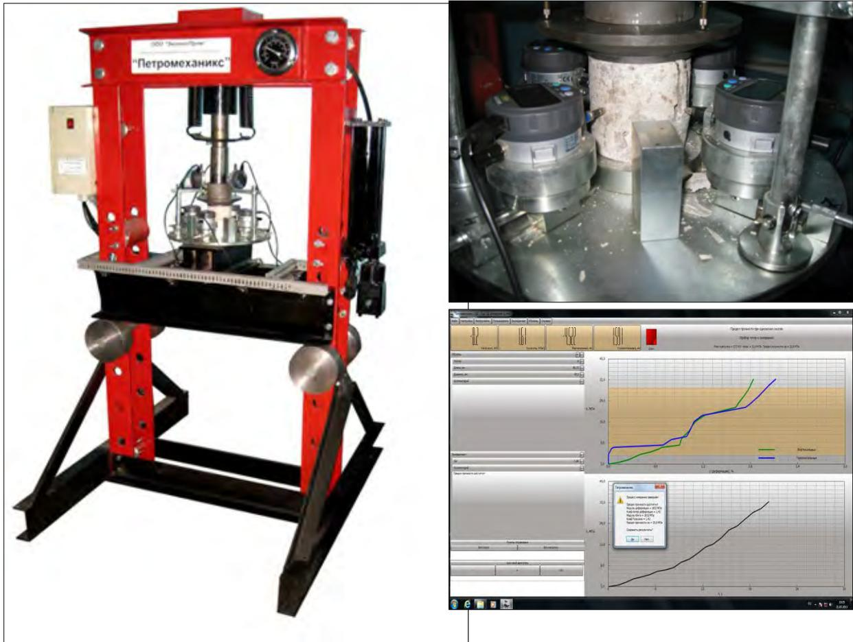
Рис. 2. Система испытаний «Петромеханикс» и рабочее окно программы обработки информации, получаемой с прибора
