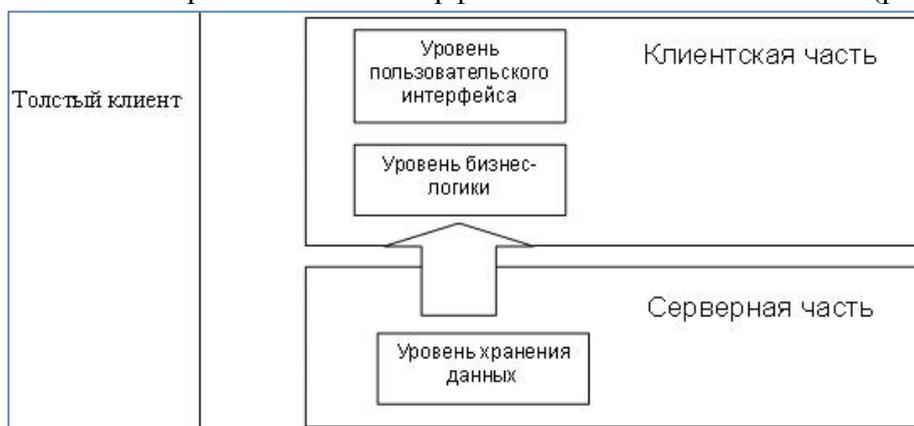
Рис. 1. Двухзвенная модель клиент-серверной архитектуры
