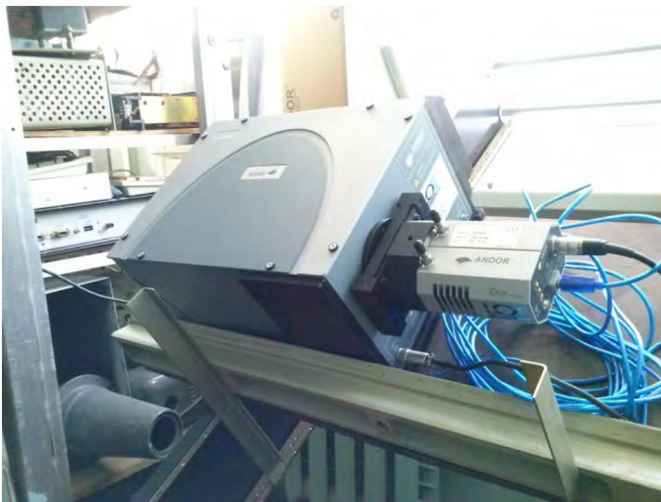
Рис. 1. Общий вид инфракрасного спектрографа Shamrock
