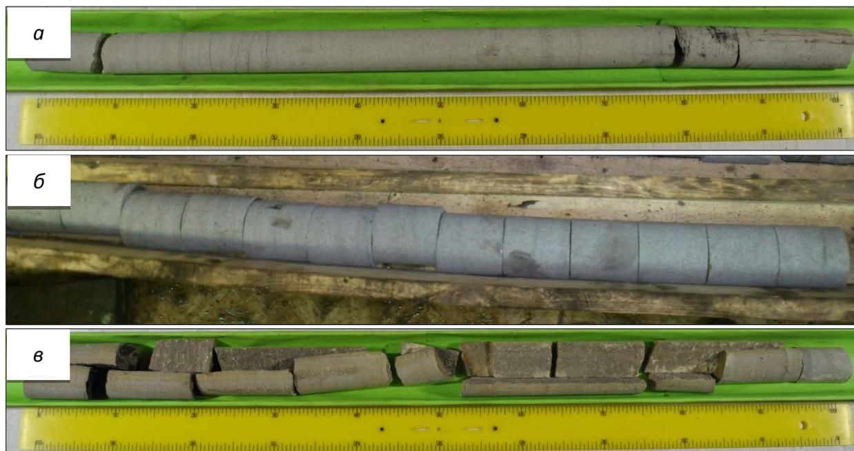
Рис. 1. Подготовка образцов тонкозернистого песчаника для лабораторных испытаний
