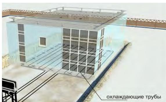
Рис. 2. Пример установки охлаждающих труб под здание
