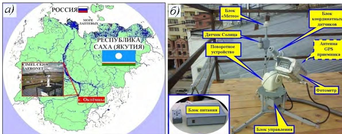
Рис. 2 (а, б). Вид и расположение солнечного фотометра марки CIMEL CE-318 на полигоне ИКФИА «ШАЛ» (а) и SP-9 на крыше здания Института в г. Якутск (б)
