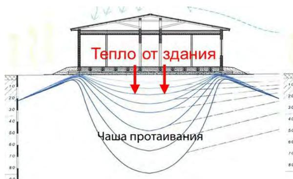
Рис. 1. Пример оттайки грунта
