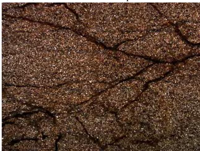
Рис. 2. Фото шлифа алевролита при десятикратном увеличении с ярко выраженными микротрещинами
