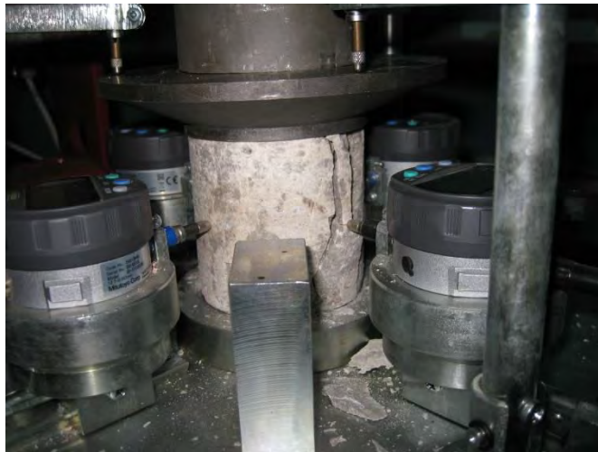
Рис. 2. Пример испытания образца на установке «Петромеханикс»
