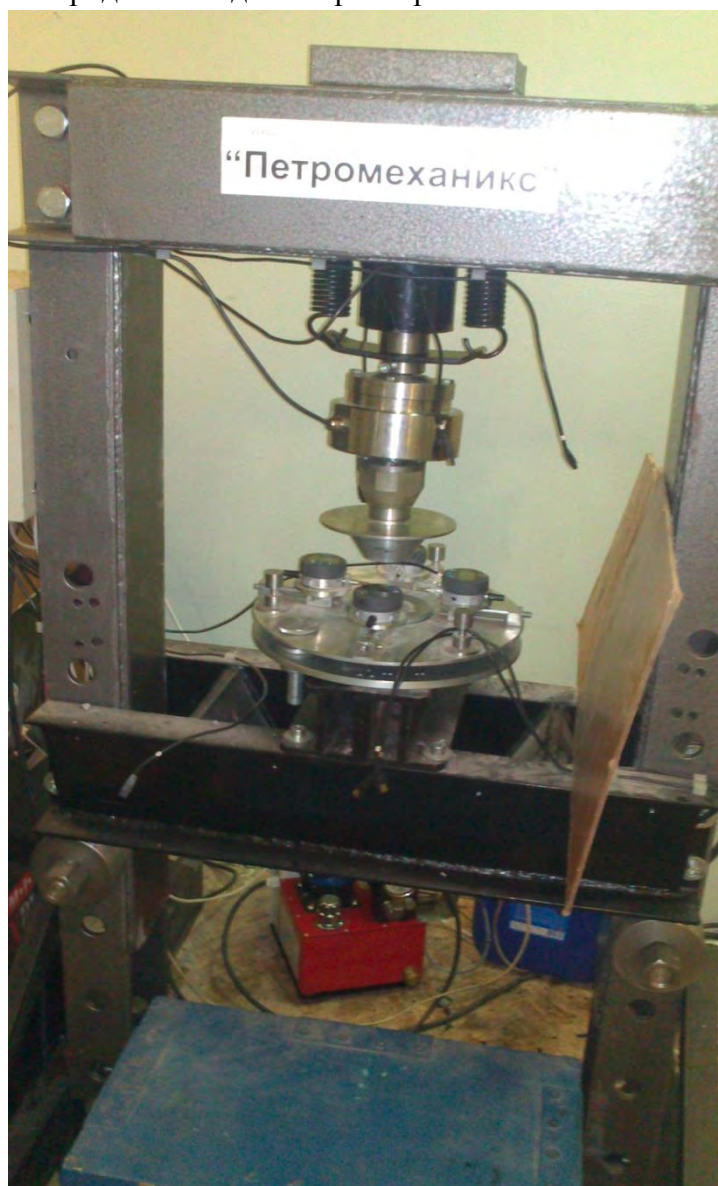
Рис. 1. Установка по исследованию механических свойств керна «Петромеханикс»
