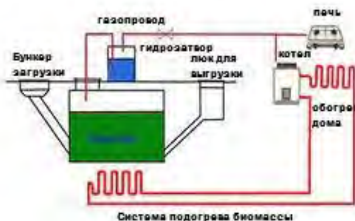
Рис. 2. Система подогрева биомассы [3]
