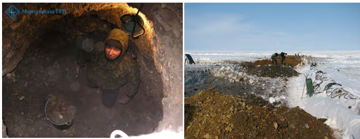
Рис. 1. Проходка разведочного шурфа
