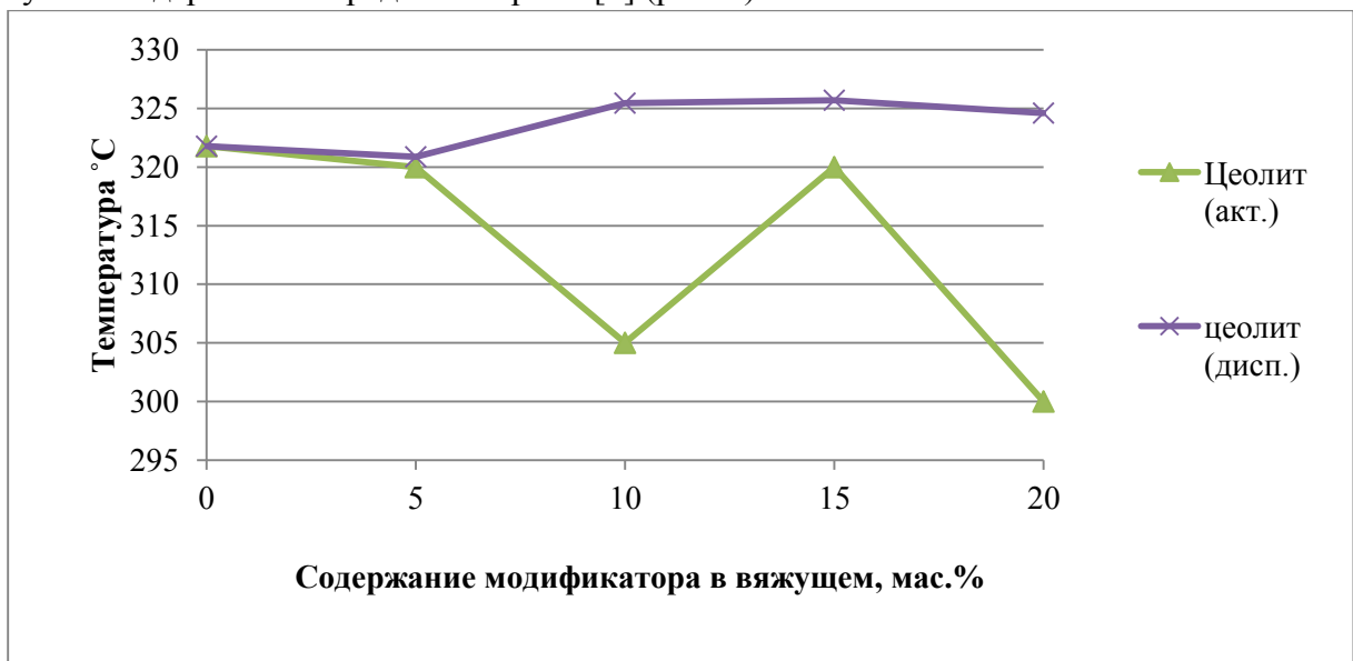
Рис. 5. Зависимость значения температуры вспышки битума от концентрации цеолита
