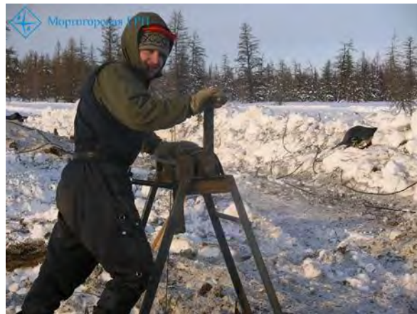
Рис. 2. Ручной подъем пробы из шурфа
