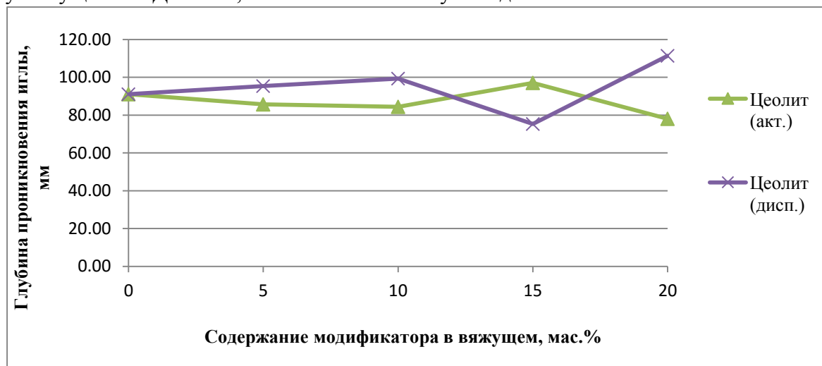
Рис. 1. Зависимость значения пенетрации битума от концентрации цеолита
