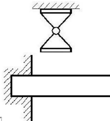
3. Однородная балка **AB** весом 4 кН давит на гладкую стену силой 3 кН. Определить реакцию опоры **A**.
