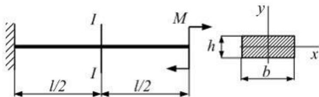
Консольная балка длиной  $l=80$  см нагружена моментом  $M=40$  Нм. Поперечное сечение балки прямоугольник:  $b=4$  см,  $h=0,6$  см. Модуль упругости материала  $E = 2 \cdot 10^5$  МПа. Радиус кривизны балки в сечении I-I равен \_\_\_\_ (м).
