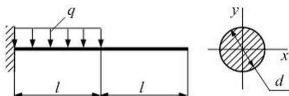
Консоль на половине длины нагружена равномерно распределенной нагрузкой интенсивности  $q = 20 \frac{kH}{m}$ . Модуль упругости материала балки  $E = 10^4$  МПа размер  $l=2$  м Прогиб на свободном конце консоли не должен превышать  $[\delta]=1$  см. Из условия жесткости диаметр поперечного сечения  $d$  равен \_\_\_\_ (см).
