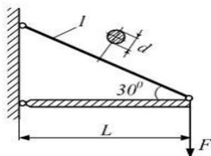
Абсолютно жесткий элемент (заштрихованный) поддерживается упругим стержнем 1. Сила  $F$ , длина  $L$ , диаметр  $d$  и модуль упругости материала стержня  $E$  известны. Линейная продольная деформация стержня 1 равна ...
