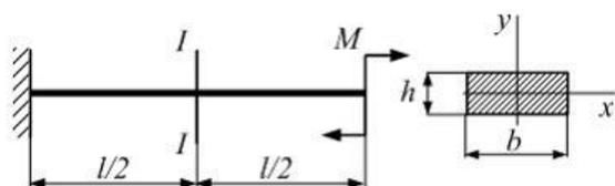
Консольная балка длиной  $l=80$  см нагружена моментом  $M=40$  Нм. Поперечное сечение балки прямоугольник:  $b=4$  см,  $h=0,6$  см. Модуль упругости материала  $E=2 \cdot 10^4$  МПа. Радиус кривизны балки в сечении I-I равен \_\_\_\_ (м).
