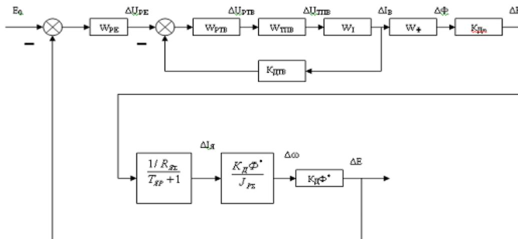
Рис. 1.2, б. Структурная схема для второй зоны регулирования
