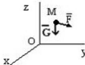
2. На материальную точку М массы  $m = 1\text{ кг}$ , кроме силы тяжести  $G$ , действует сила  $F = 9,8\text{ кН}$ . Ускорение свободного падения принять  $g = 9,8\text{ м/с}^2$ . В начальный момент точка двигалась вниз. Смотри рис. задания 1
