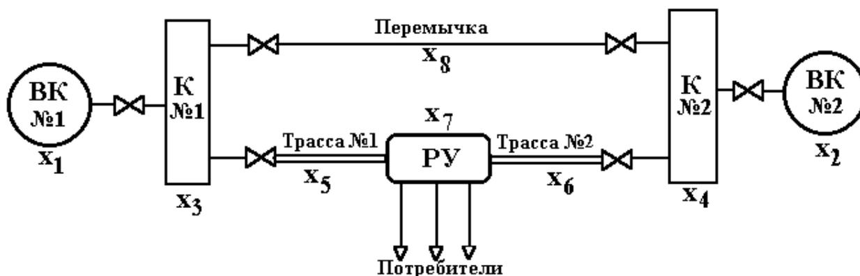
Возможно ли обеспечение бесперебойного теплоснабжения потребителей при неисправности котла №1:
