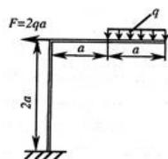
Если рама находится под воздействием горизонтальной силы  $F$ , то наибольшая величина поперечной силы по модулю равна:
