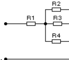
сопротивлениях резисторов  $R_1=1$  Ом,  $R_2=R_3=2$  Ом,  $R_4=3$  Ом.
