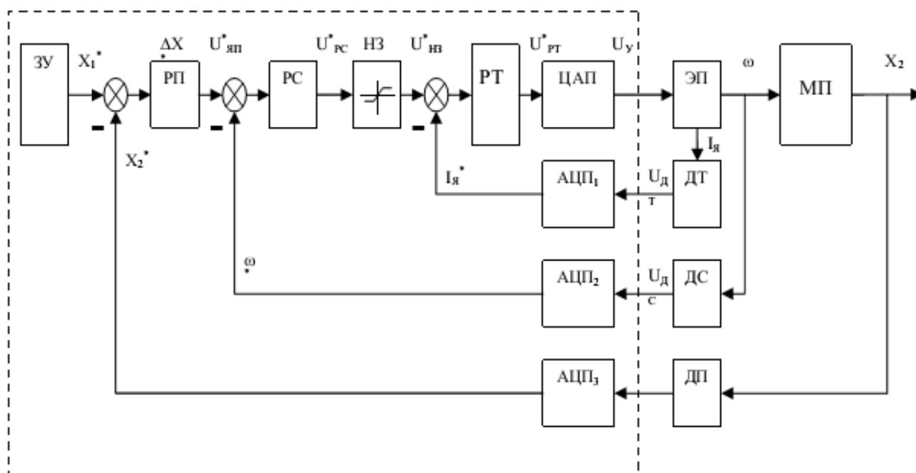
Рис. 1.1. Функциональная схема следящей САУ
