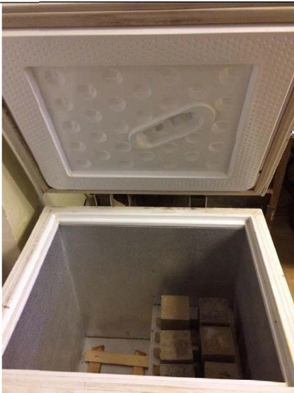
Предназначена для проведения контроля морозостойкости бетона по ГОСТ 10060-2012 базовым первым и ускоренным вторым методами, кирпича керамического и силикатного и других материалов.
