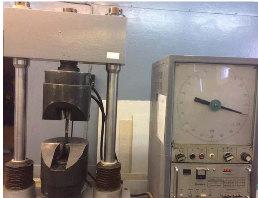
Предназначена для испытаний на растяжение арматурной стали (проволоки, стержни и арматурные канаты) круглого и периодического профиля, предназначенных для армирования обычных и предварительно напряжённых железобетонных конструкций с целью определения:
