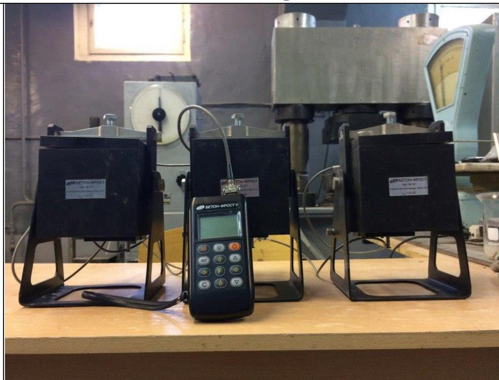
Прибор для измерения объёмных деформаций бетона дилатометрическим методом. Ускоренное определение морозостойкости бетона по величине аномальных пиков объёмных деформаций при замораживании. Позволяет прогнозировать и определять морозостойкость бетона в течение суток.
