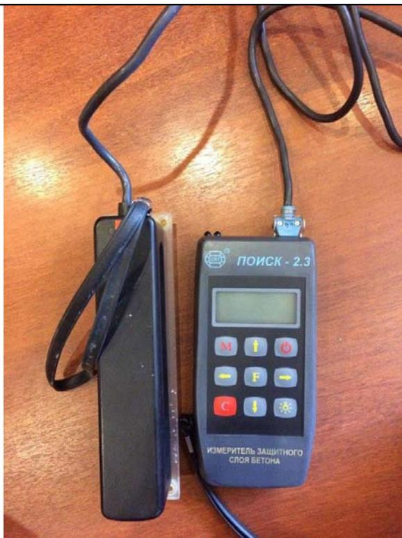
Прибор предназначен для измерения толщины защитного слоя бетона (расстояние по нормали от поверхности бетона до образующей арматурного стержня), определения расположения (проекция арматуры на поверхность бетона) и диаметра арматуры в диапазоне 3...50 мм в железобетонных изделиях и конструкциях при параметрах проектирования в условиях предприятий, стройплощадок, эксплуатируемых зданий и сооружений.
